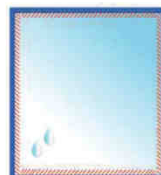
Geringerer Wärmeverlust durch die warme Randzone. Reduktion von Kondensat auf der Fenster-Innenseite.
