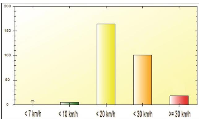
Von 288 gemessenen Kraftfahrern hielt sich kein einziger an die vorgeschriebene Schrittgeschwindigkeit von max. 7 km/h. Nur fünf lagen zumindest unterhalb von 10 km/h, 164 unter 20 km/h, 101 fuhren zwischen 20 und 30 km/h und 18 Verkehrsteilnehmer überschritten sogar diese Marke, davon einer mit 45 km/h.
